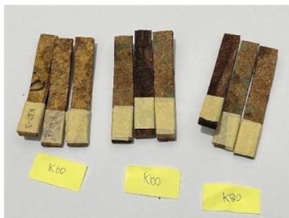
**Gambar 3.10** Sampel Uji *Bending* Setelah Penguujian
