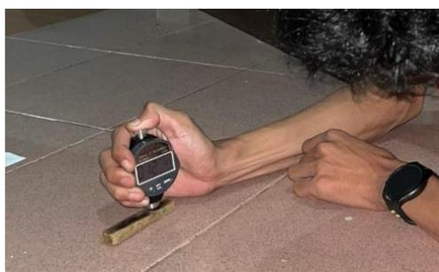
**Gambar 3.9** Pengujian Kekerasan
