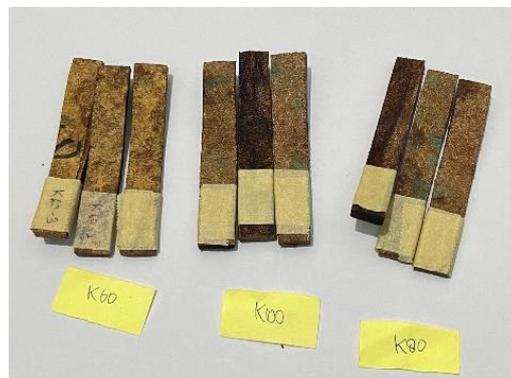
**Gambar 3.10** Sampel Uji *Bending* Setelah Pengujian
