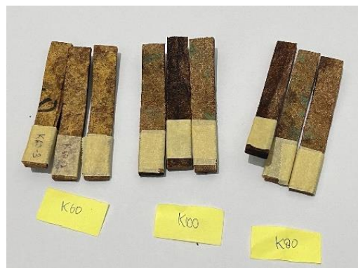
Gambar 3.10 Sampel Uji Bending Setelah Pengujian
