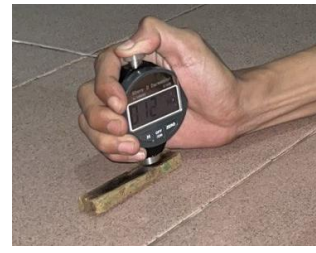
Gambar 3. Proses Uji Kekerasan
