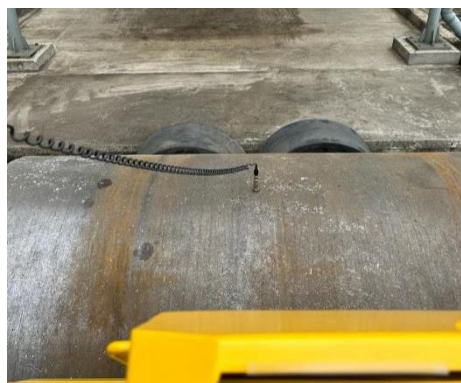
Gambar 4.3 Peletakkan sensor pada tengah roll
