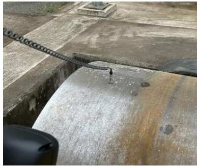
Gambar 4.2 Peletakkan sensor pada kiri roll
