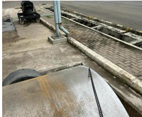
Gambar 4.4 Peletakkan sensor pada kanan roll
