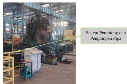
**Gambar 3.4** Sistem Pemotongan dan Pengumpanan Pipa
