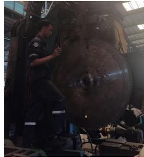
**Gambar 4.6** Membuka Pengunci *Blade Cutting*
