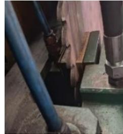
**Gambar 4.12** Pengukuran Gap antara clamp dengan *Blade Cutting*
