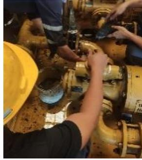
**Gambar 4.13** Penggantian *Butterfly Valve* di HPU *Pipe Cutting*
