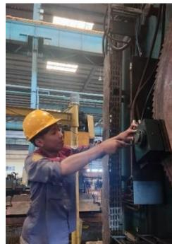
**Gambar 4.5** Membuka Clamp Bagian Depan
