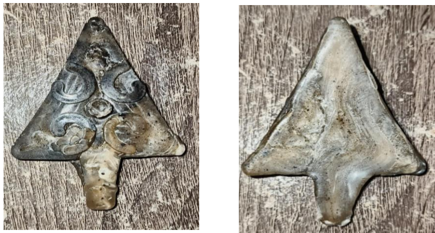
Gambar 4.7 Hasil Benda Kerja dengan konsentrasi HDPE (30%), PET (20%), dan PP (50%).
