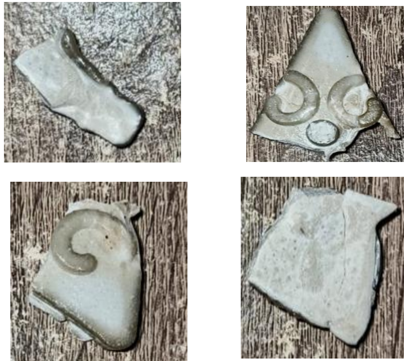
Gambar 4.8 Cacat Yang Terjadi Pada Hasil Benda Kerja
