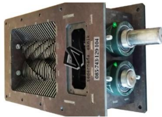
Gambar 3.3 Mesin Penghancur Plastik
