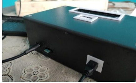
Gambar 4.12 Memasukkan SD Card dan Menyambungkan Kabel Daya serta Kabel Probe Sensor Ultrasonik.
