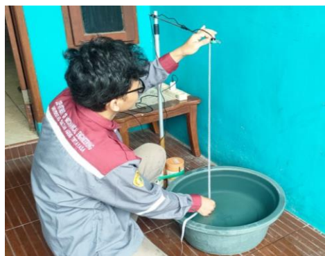
Gambar 4.15 Mengukur Kembali Jarak Antara Probe dan Permukaan Air.
