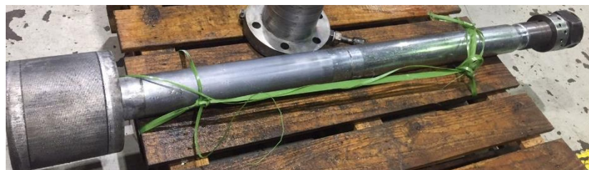
Gambar 4.3 Scratch pada Piston Rod Stage 2
