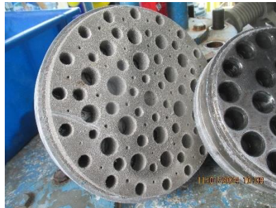
Gambar 4.2 Loader valve yang Kotor
