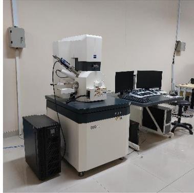
**Gambar 3.9** Alat Pengamatan Struktur Mikro
