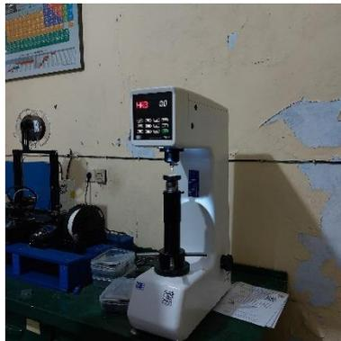
**Gambar 3.10** Alat Uji Kekerasan
