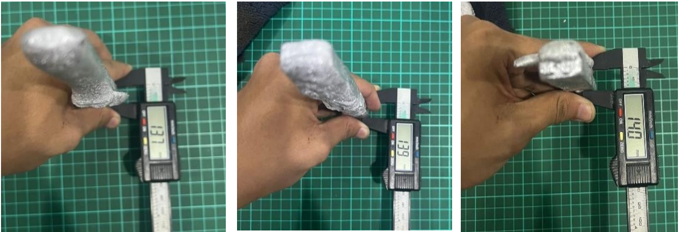
Gambar 4.1 Spesimen 1,2, dan 3 sebelum thixoforming
