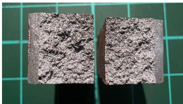
Gambar 4.4 Hasil patahan uji impak waktu tahan 1 jam
