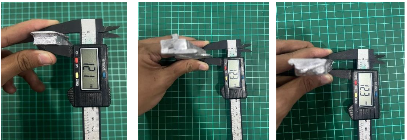
Gambar 4.2 Spesimen 1,2, dan 3 setelah Thixoforming
