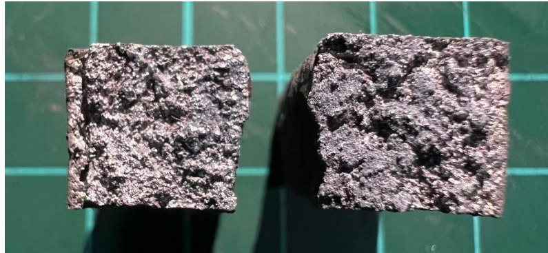
Gambar 4.6 Hasil patahan uji impak waktu tahan 3 jam
