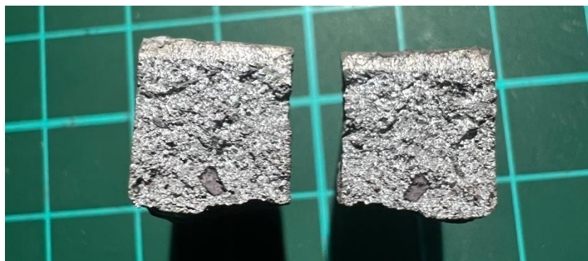
Gambar 4.5 Hasil patahan uji impak waktu tahan 2 jam
