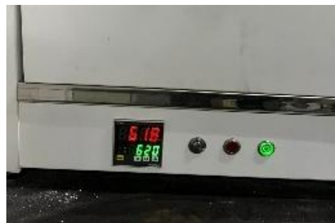
Gambar 3.13 Pemanasan hingga suhu 620^{\circ}\text{C}
