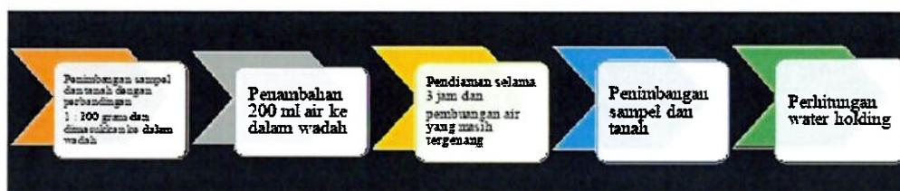
**Gambar 3.3** Metoda pengukuran kapasitas menampung air
