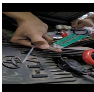
Gambar 3. Pengukuran Flowmeter Sistem EGR
