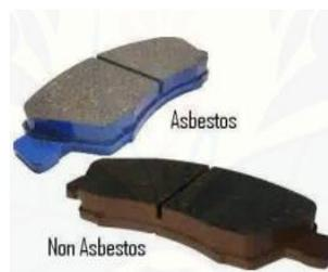
**Gambar 2.2** Kampas Rem *Asbestos* dan *Non Asbestos*
