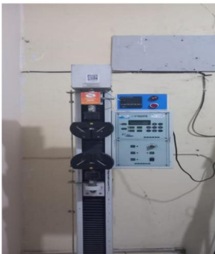
**Gambar B.7** Mesin Uji Tarik
