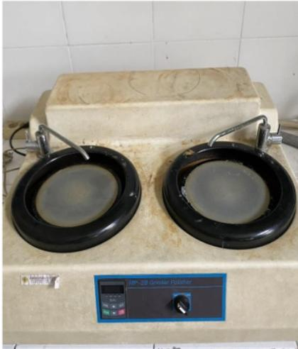
**Gambar B.1** Mesin *Grinding* dan *Polishing*
