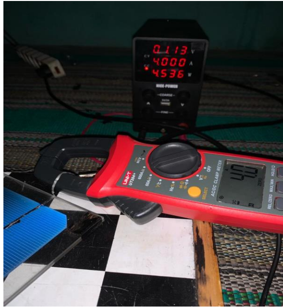
Gambar 5 Pengukuran sel surya dengan ampere meter 4 Ampere
