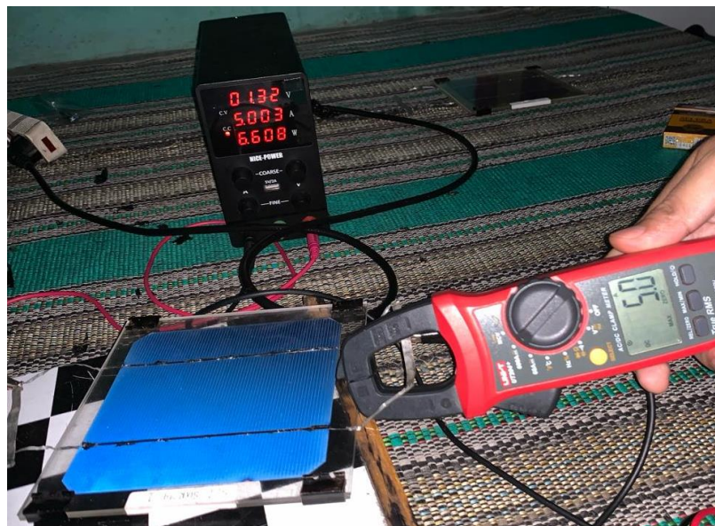
Gambar 6 Pengukuran sel surya dengan ampere meter 5 Ampere
