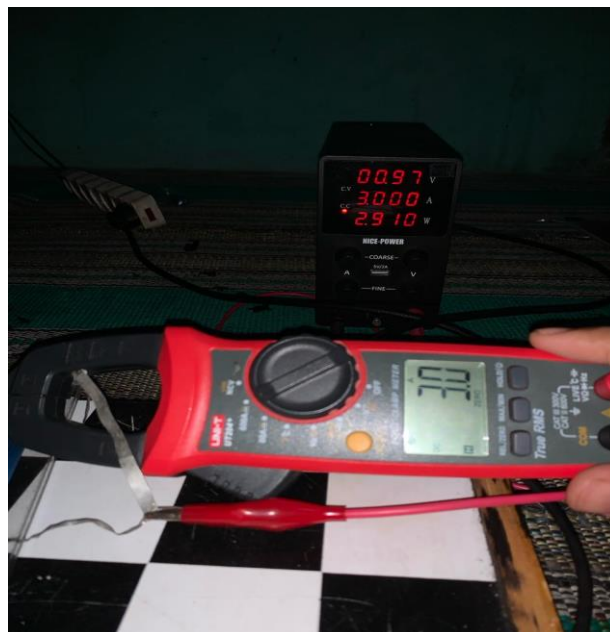
Gambar 4 Pengukuran sel surya dengan ampere meter 3 Ampere
