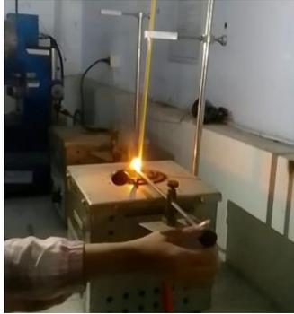
Gambar 5.8 Pengujian Titik Nyala dan Titik Bakar
