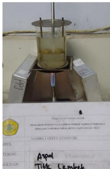
Gambar 5.9 Pengujian Titik Lembek
