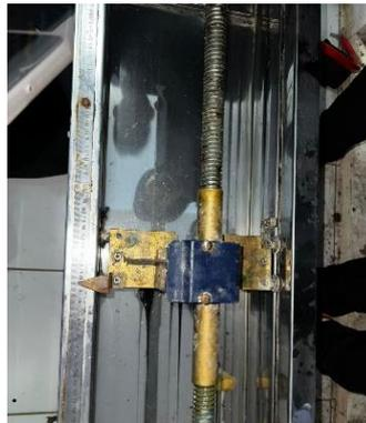
Gambar 5.7 Pengujian Daktilitas Aspal
