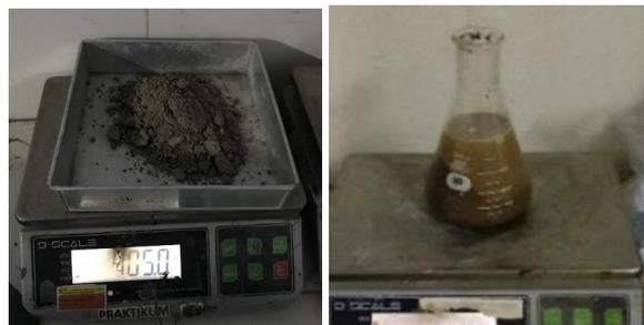
Gambar 5.3 Pengujian Berat Jenis dan Penyerapan Agregat Halus
