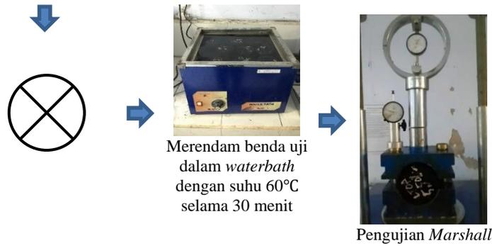
Gambar 5.19 Proses Pengujian Penuaan LTOA
