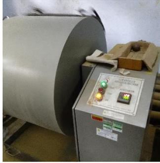
Gambar 5.2 Pengujian Keausan Agregat Kasar
