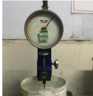
Gambar 5.5 Pengujian Penetrasi Aspal
