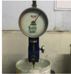
Gambar 5.5 Pengujian Penetrasi Aspal (Sumber: Analisa Penulis, 2024)
