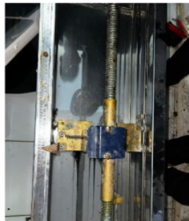
Gambar 5.7 Pengujian Daktilitas Aspal
