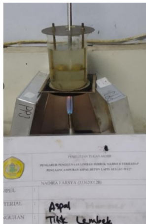
Gambar 5.9 Pengujian Titik Lembek (Sumber: Analisis Penulis, 2024)
