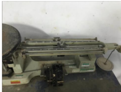
4 Gambar 5.1 Pengujian Berat Jenis dan Penyerapan Agregat Kasar (Sumber: Analisa Penulis, 2024)
