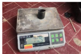
Gambar 5.6 Pengujian Berat Jenis Aspal (Sumber: Analisa Penulis, 2024)
