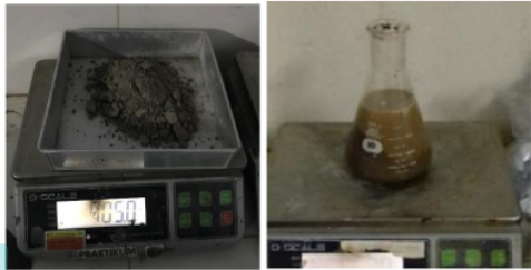
Gambar 5.3 Pengujian Berat Jenis dan Penyerapan Agregat Halus (Sumber: Analisa Penulis, 2024)
