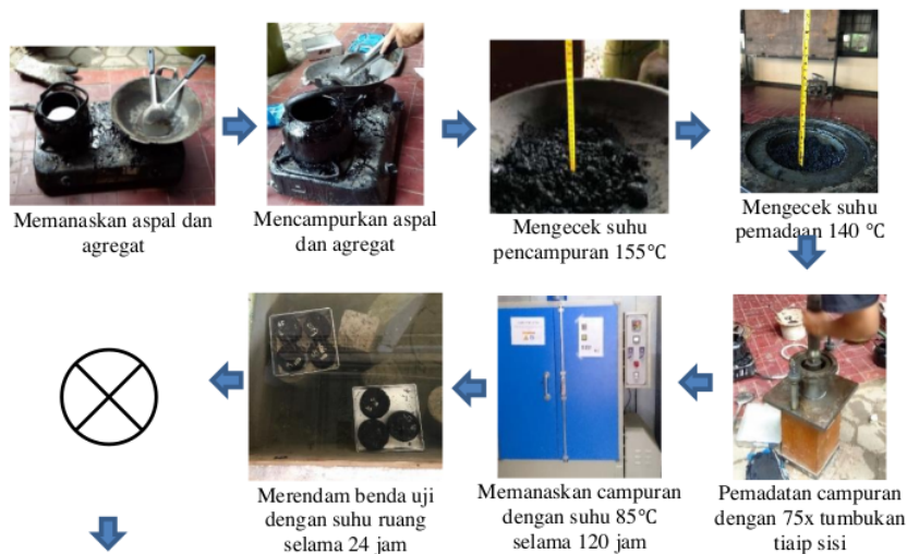
Gambar 5.18 Proses Pengujian Penuaan STOA (Sumber: Analisa Penulis, 2024)
