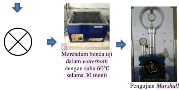
Gambar 5.19 Proses Pengujian Penuaan LTOA (Sumber: Dokumentasi Penulis, 2024)
