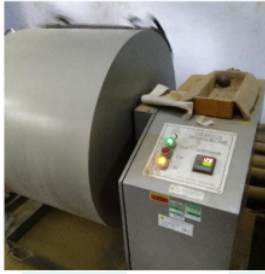
Gambar 5.2 Pengujian Keausan Agregat Kasar (Sumber: Analisa Penulis, 2024)
