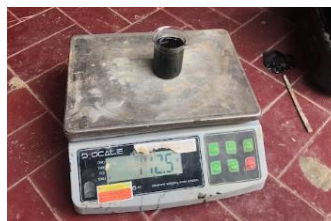
Gambar 5.6 Pengujian Berat Jenis Aspal (Sumber: Analisa Penulis, 2024)
