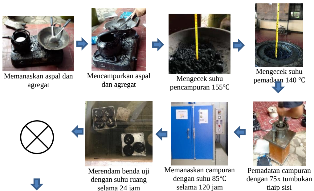
Gambar 5.18 Proses Pengujian Penuaan STOA (Sumber: Analisa Penulis, 2024)
