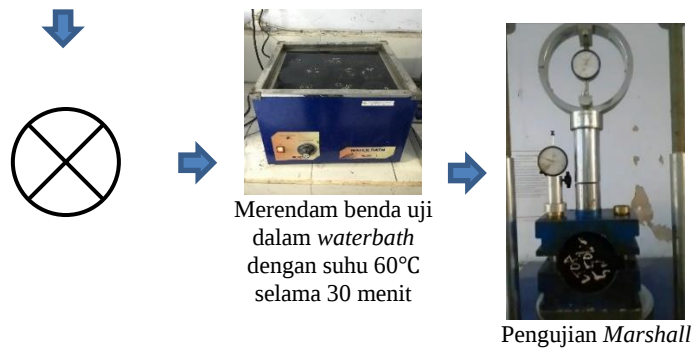
Gambar 5.19 Proses Pengujian Penuaan LTOA (Sumber: Dokumentasi Penulis, 2024)
