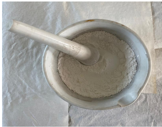
Gambar 3.3 Proses Reduksi Ukuran Sampel
