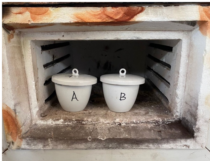
Gambar 3.4 Tahapan Proses Kalsinasi Parsial
