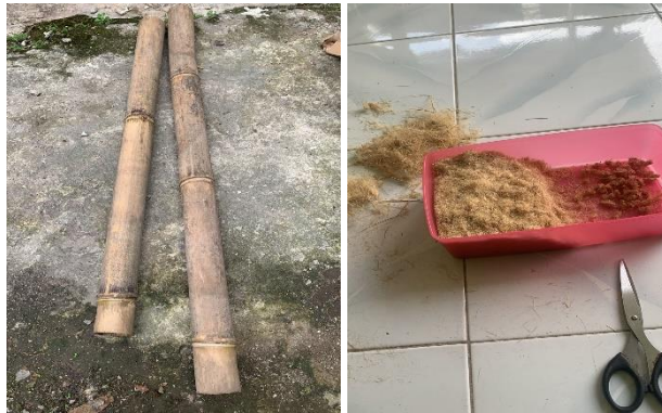
Gambar 3. 11 Pengolahan Serat Bambu
