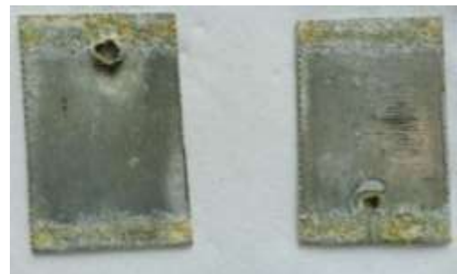
Gambar B.7 Kondisi baja setelah proses perendaman 14 hari.
