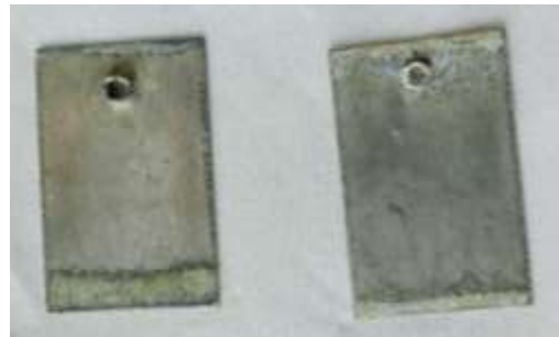
Gambar B.6 Kondisi baja setelah proses perendaman 7 hari.
