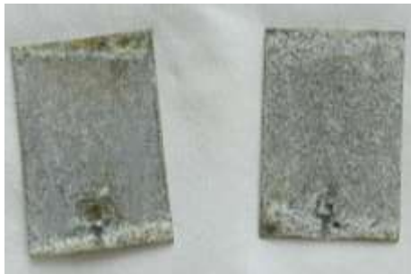
Gambar B.7 Kondisi baja setelah proses perendaman 14 hari.
