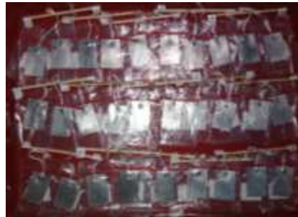
Gambar B.5 Kondisi baja sebelum proses perendaman
