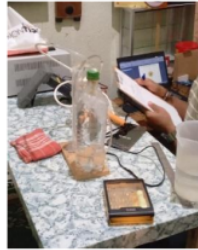
Gambar 3.12 Pengukuran Kualitatif sensor mq-8
