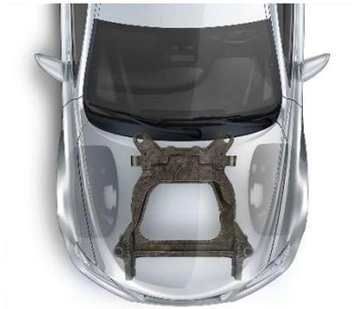
**Gambar 2.7** Rangka *SubFrame*
