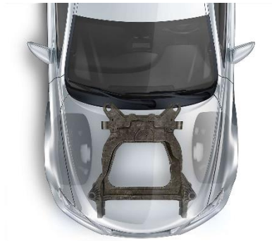
Gambar 2.7 Rangka SubFrame (Sumber: carvaganza.com)
