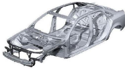
Gambar 2.6 Rangka Monocue (Sumber: kompasotomotif.com)
