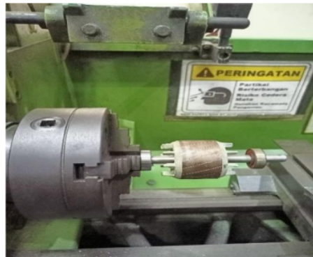
Gambar 4.5 Proses Pembubutan Rotor
