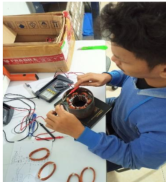
Gambar 4.9 Proses Pengukuran Resistansi pada Kawat
