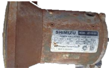
Gambar 3.2 Nameplate Motor Induksi
