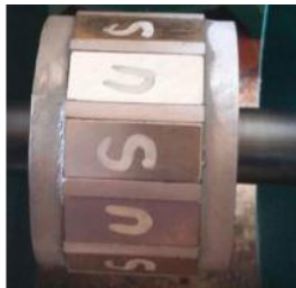
Gambar 2.7 Rotor dengan Magnet Permanen [21]
