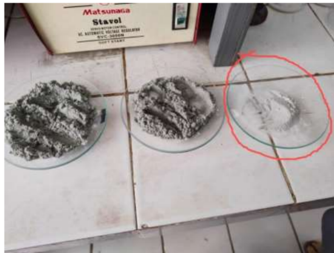
Gambar 7.10 Preparasi katalis Zeolit Alam Lampung
