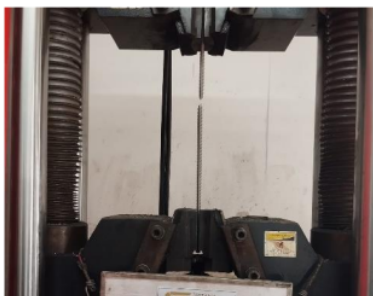
Gambar 5.17 Proses Pengujian Tarik Baja Tulangan
