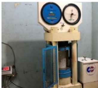
Gambar 5.16 Proses Pengujian Kuat Tekan Beton
