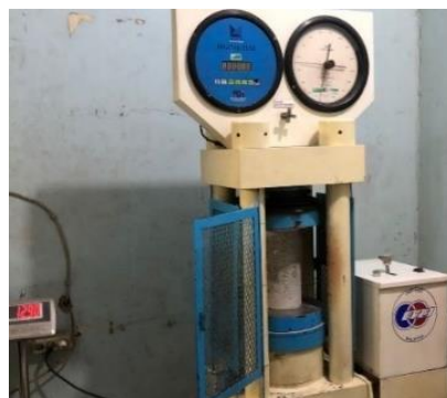
Gambar 5.16 Proses Pengujian Kuat Tekan Beton
