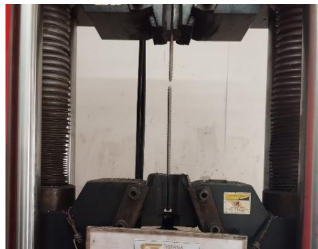
Gambar 5.17 Proses Pengujian Tarik Baja Tulangan
