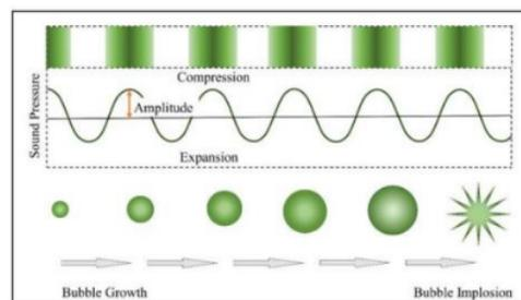
**Gambar 2.9** Mekanisme pembuatan nanopartikel dengan metode ultrasonikasi (Shojaearani et al., 2020)
