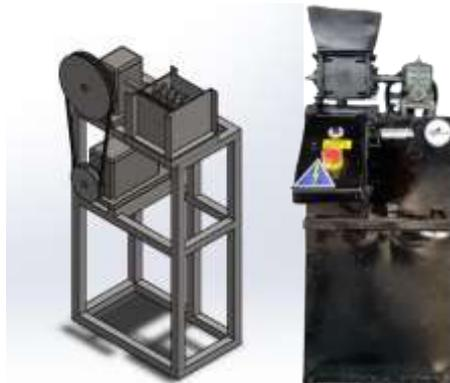
**Gambar 4.1** Mesin Pencacah Plastik
