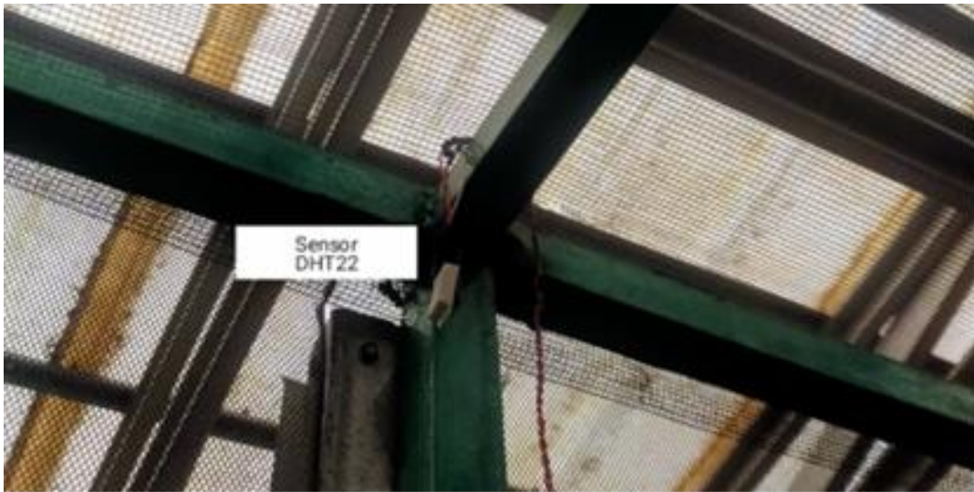
Gambar A.3 Posisi Penempatan Sensor DHT22 untuk Suhu dan Kelembaban
