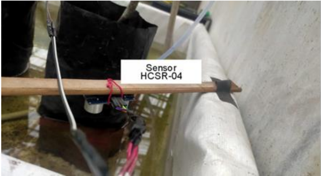
Gambar A.5 Posisi Penempatan Sensor Ultrasonik HC-SR04
