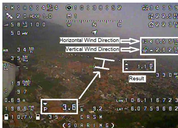
Gambar B.30 OSD Ketika Mengalami Thermal Uplift
