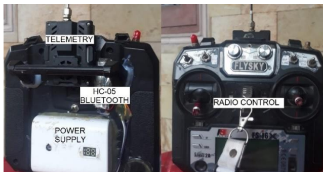
Gambar 4.5 RC Transmitter dengan 915MHz ELRS dan HC-05 module
