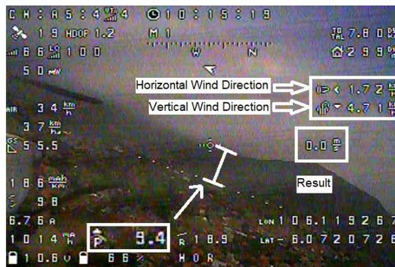
Gambar B.29 OSD Ketika Tidak Ada *Thermal Uplift*
