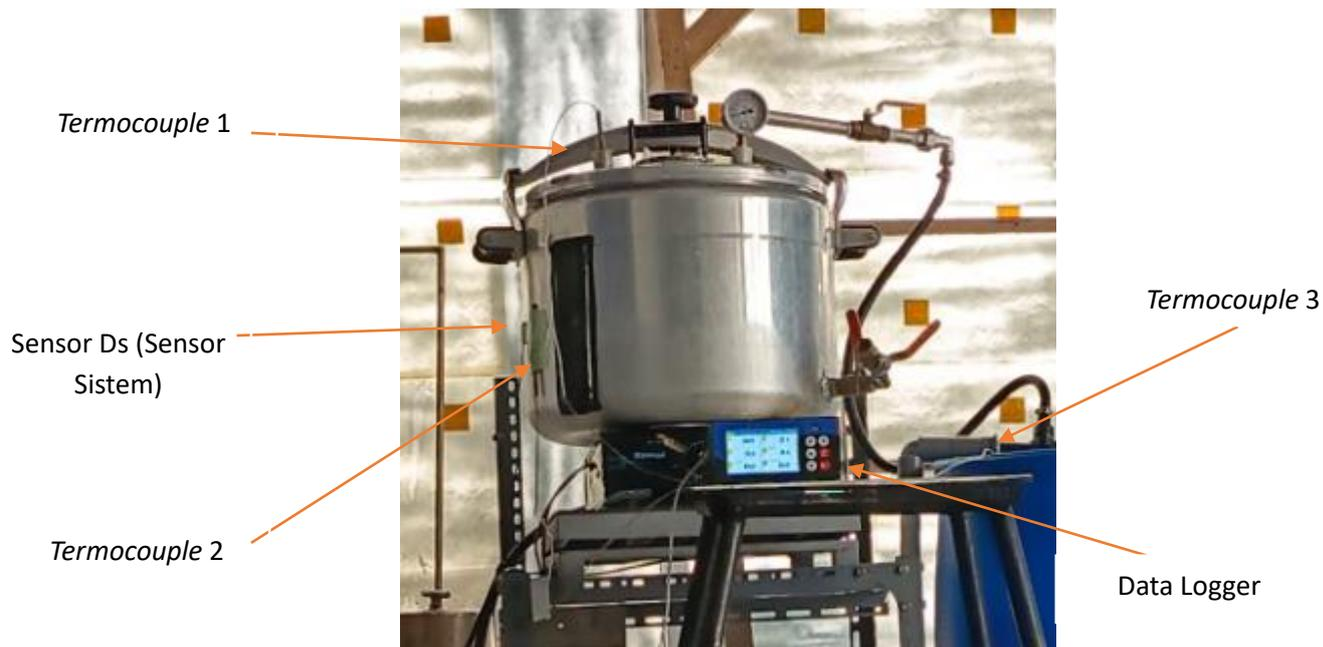
**Gambar 4.12** Penempatan sensor pada alat
