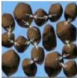
Gambar 3.3 Kondisi Partikel Tanah saat Mengalami Getaran
