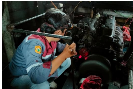
Gambar 3.10 Pengukuran Putaran Engine dan Propeller
