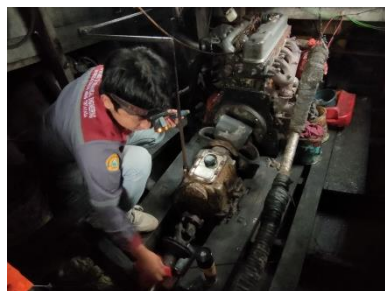
Gambar 3.8 Membersihkan Titik Pengukuran Tachometer
