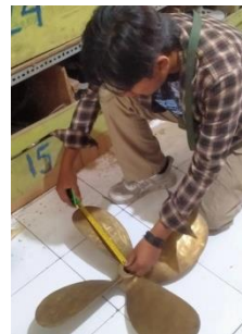
Gambar 3.7 Pengukuran Dimensi Propeller
