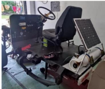
Gambar 4.2 Pemasangan Solar Panel
