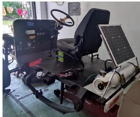
**Gambar 4.2** Pemasangan Solar Panel
