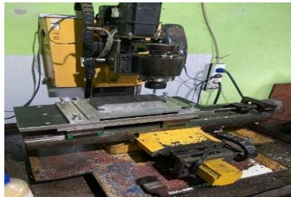
**Gambar 4.9** Mesin *CNC Router 3040*
