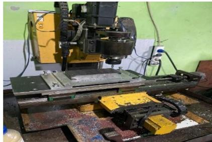
**Gambar 4.9** Mesin *CNC Router 3040*
