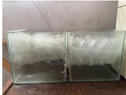
Gambar 9. Bak Biofilter Anaerob dan Aerob
