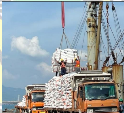
Gambar 12. Membongkar muatan beras dari palka kapal ke trailer
