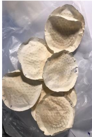
Gambar 13. Penimbangan Kertas Saring hingga Berat Konstan pada Uji Persentase Derajat Substitusi
