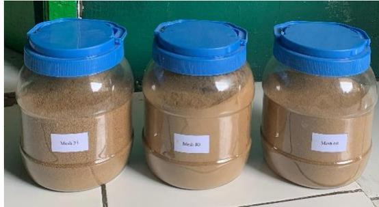
**Gambar 3.14** Partikel Pelepah Kelapa Sawit
