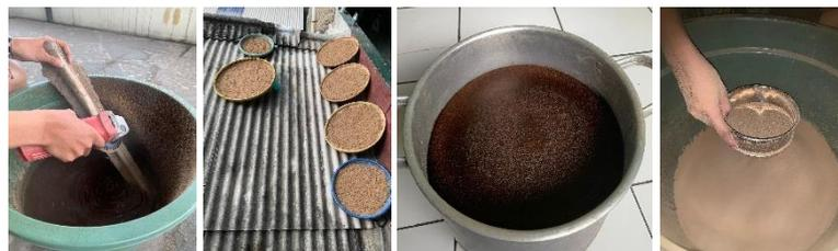
**Gambar 3.20** Pembuatan Partikel Pelepah Kelapa Sawit
