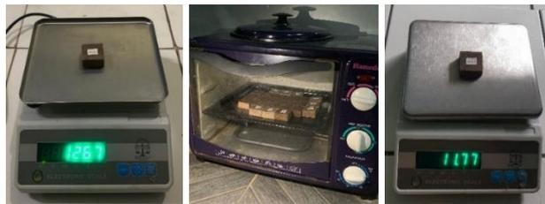
**Gambar 3.26** Uji Kadar Air
