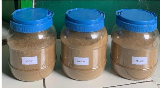
**Gambar 3.14** Partikel Pelepah Kelapa Sawit
