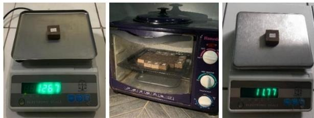
**Gambar 3.26** Uji Kadar Air
