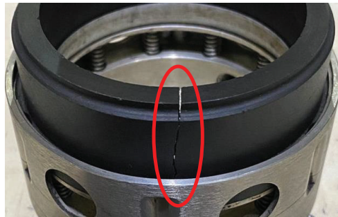
Gambar 4.10 Crack pada Carbon Mechanical Seal
