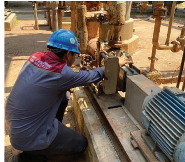
Gambar 4.8 Pengukuran Vibrasi pada Pompa Sentrifugal G-930 A
